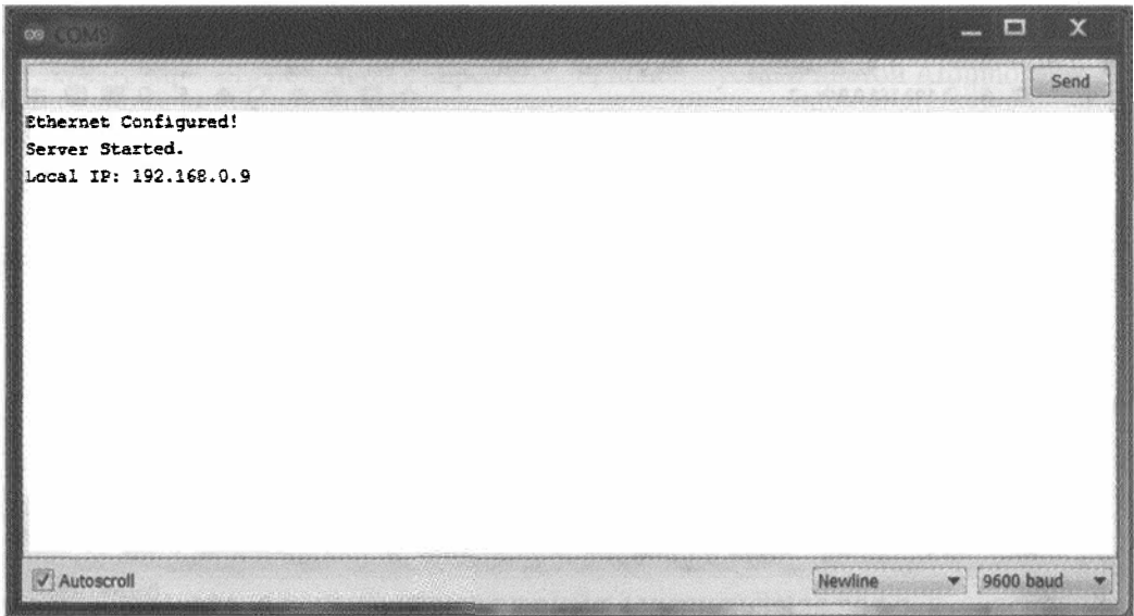
Рис. 14.4. Вывод в последовательный порт полученного по DHCP IP-адреса
