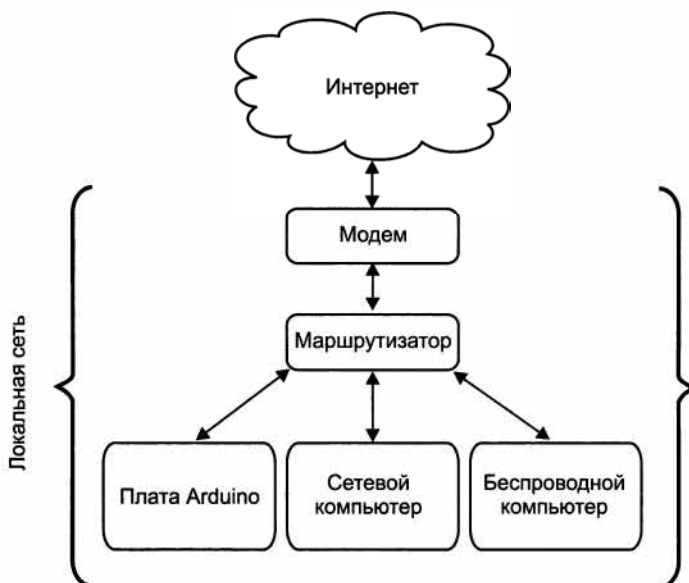
Рис. 14.1. Упрощенная схема взаимодействия Интернета и локальной сети
