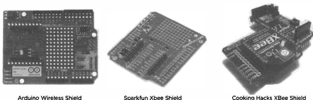
Рис. 11.4. Внешний вид различных плат расширения для подключения модулей XBee
